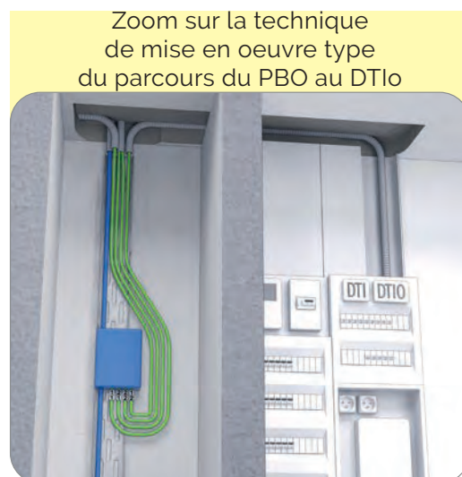
Fig. 35 | Colonne de communication type pour les immeubles \geq à 12 logements et/ou locaux à usage professionnel toutes zones confondues
