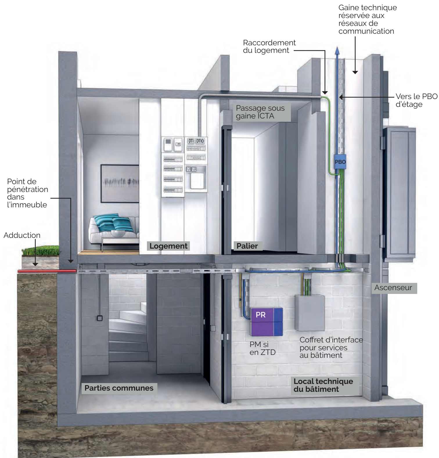
Fig. 01 | Cas d'une installation avec colonne de communication composée de PBO dans les étages
