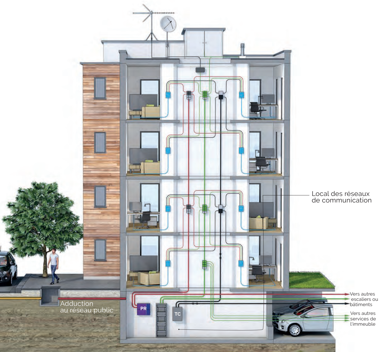
Fig. 100 | Concept de la colonne optique de services
