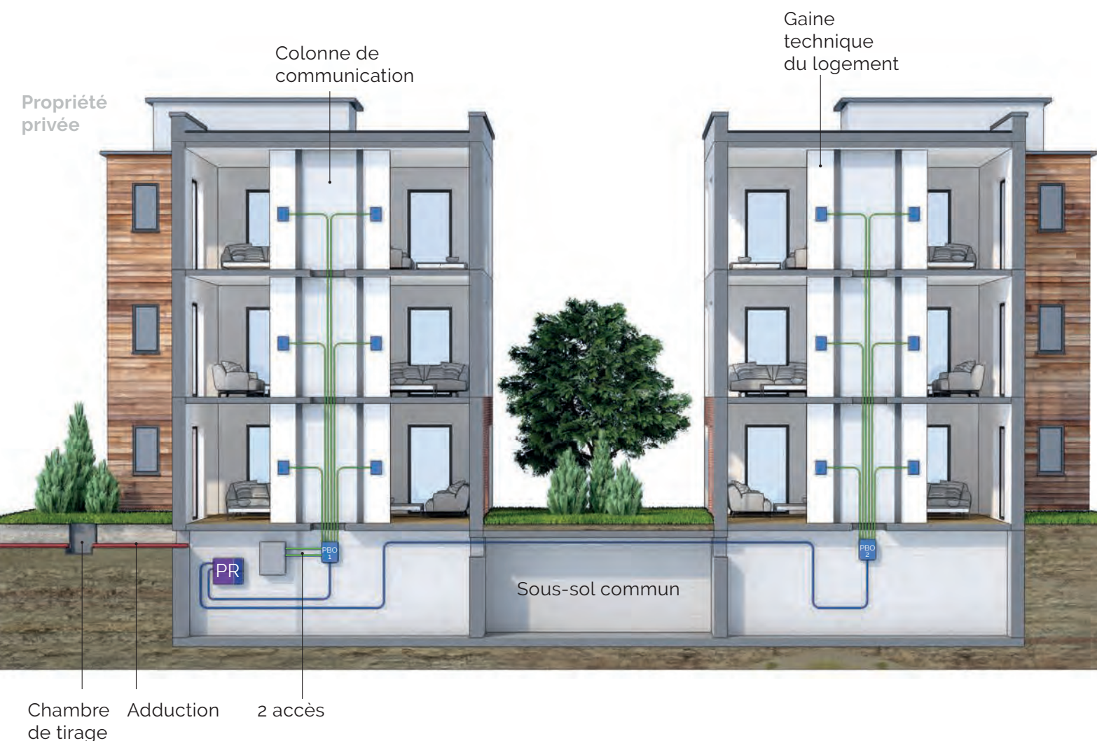
Fig. 46 | Cas d'un campus composé de bâtiments \leq à 12 accès sur sous-sol commun, avec câblage sans PBO dans les colonnes montantes - 1 seul PBO par immeuble en sous-sol
