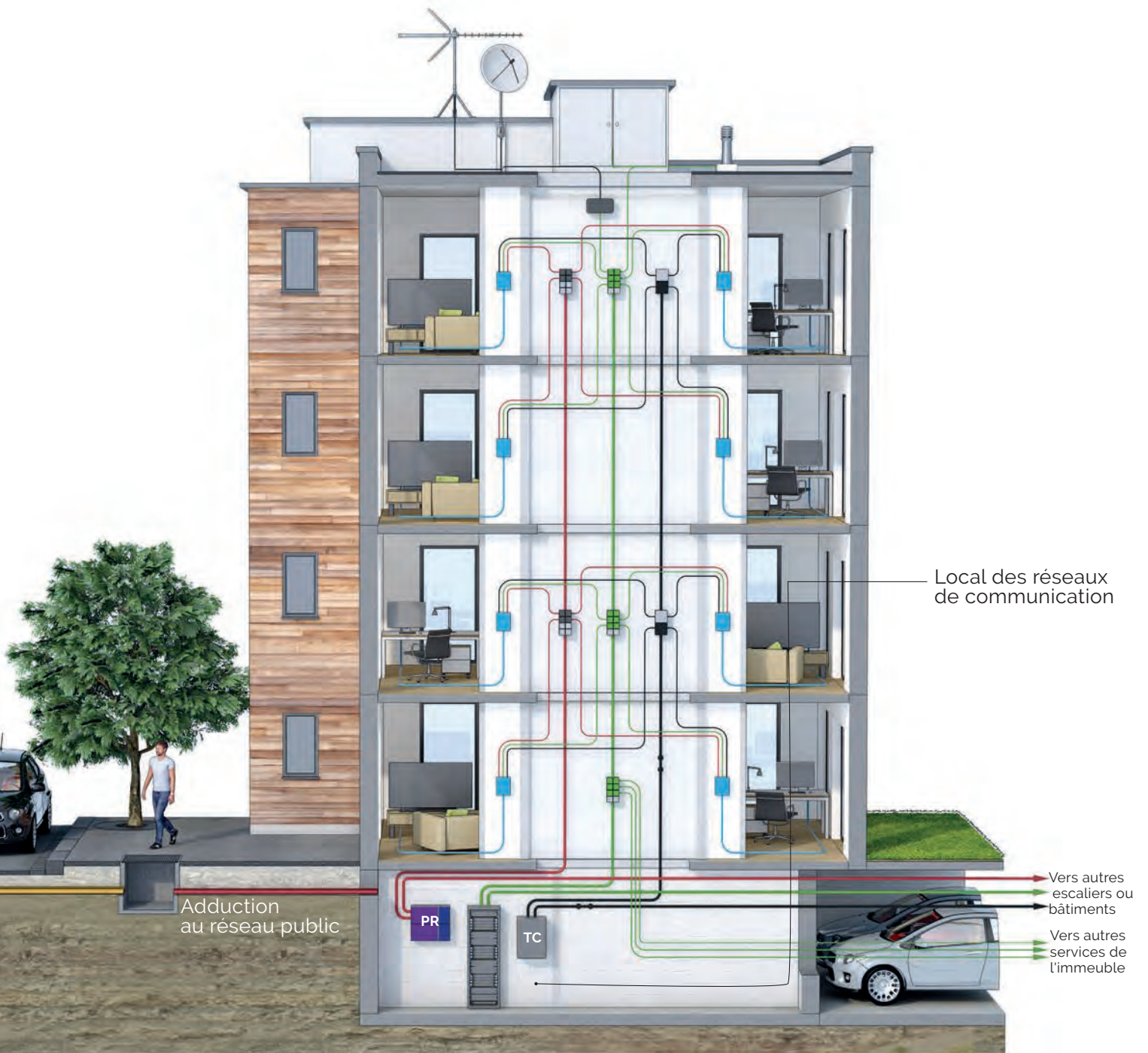
Fig. 100 | Concept de la colonne optique de services
